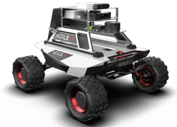
Figure 11: AgileX scout mini UGV.
